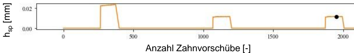
Abbildung 17: Konvergenz des Eingriffsparameters Spandicke für ein Minimalbeispiel
