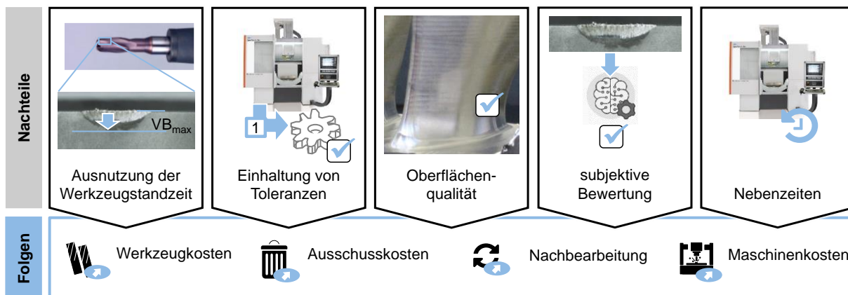
Abbildung 3: Nachteile und Folgen von Werkzeugverschleiß beim Fräsen
