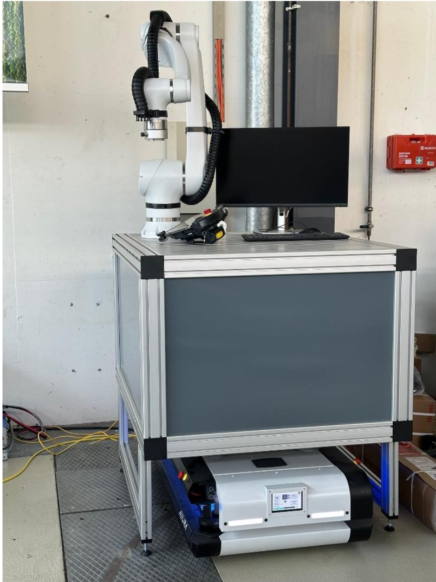
Abbildung 6: AMR mit Aluminiumprofilaufbau und kollaborativem Roboter
