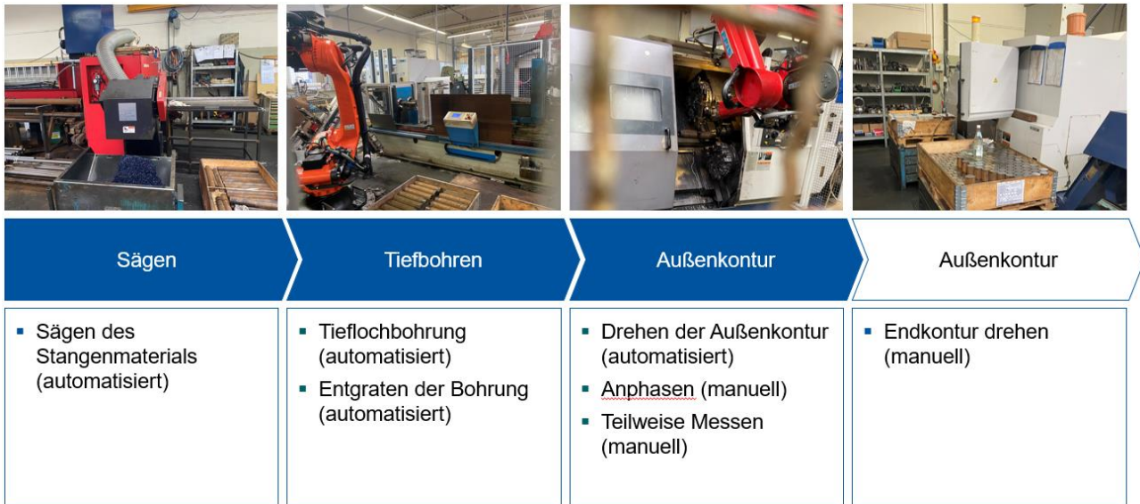
Abbildung 2: Prozessschritte für die Herstellung eines Drehteils bei THH Drehteile
